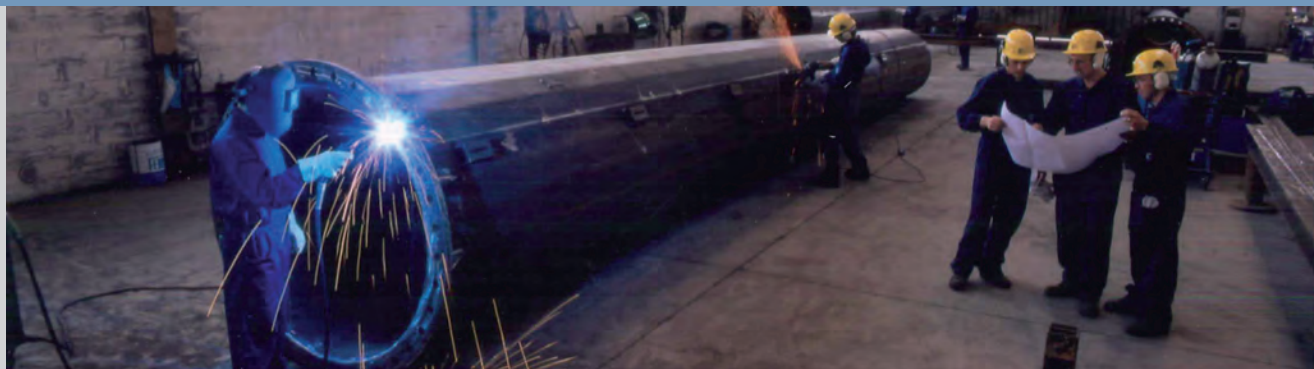
Lavorazione pali grande diametro
